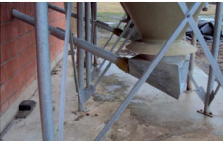
**Mehlschneckenkasten 30° für Schnecke
