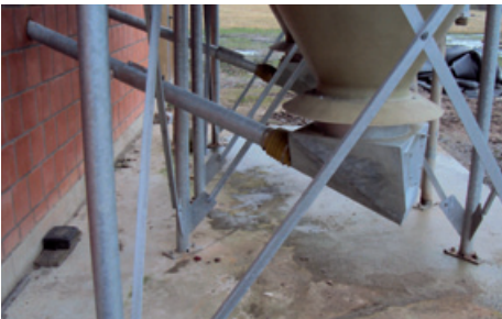
Mehlschneckenkasten 30° für Schnecke 102 mm
