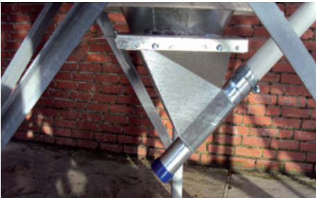
Spiralannahmekasten mit integrierten Absperrschieber
