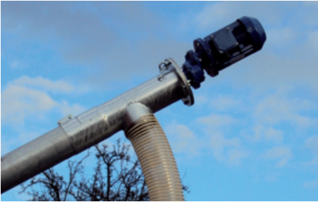
Schneckenantrieb 150 mm mit Getriebemotor 1,5 kw
